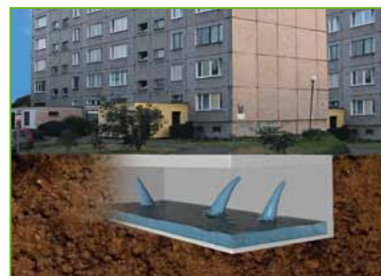
Kellerwände sind häufig nicht von außen zugänglich. Solche Wände können daher nur von innen (negativseitig) abgedichtet werden.
