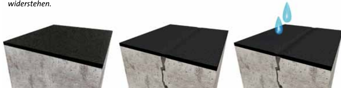
2. Rissüberbrückende Abdichtung: In diesem Fall wird durch die Schichtstärke und die Elastizität der Abdichtung dem permanenten Wasserdruck standgehalten.
