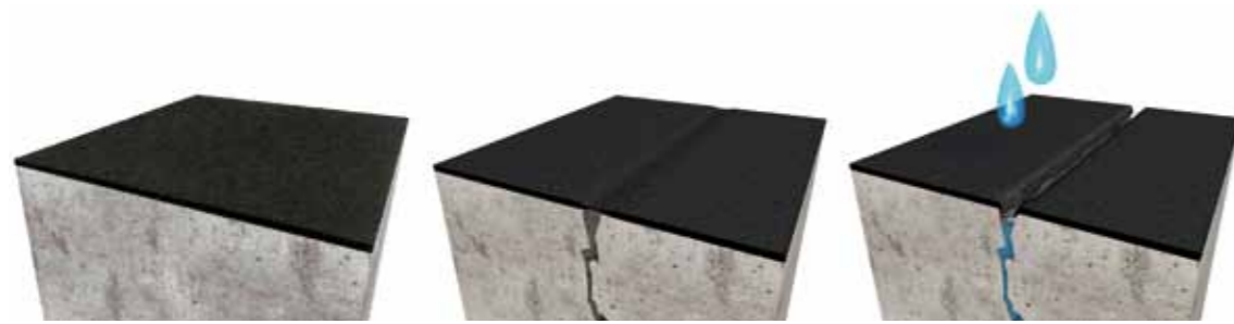
1. Elastisch aber nicht rissüberbrückend: Die Abdichtung kann dem permanenten Wasserdruck nicht widerstehen.
