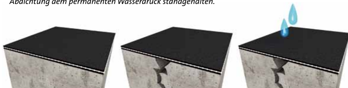
3. Rissüberbrückende Abdichtung mit Armierungsgewebe: Das Gewebe trennt die obere Abdichtungsschicht vom Riss und hilft maßgeblich dem permanenten Wasserdruck zu widerstehen.
